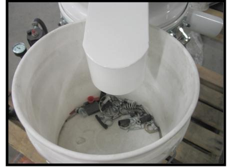
Recyclbares Sponge Media wird aus dem **Auswurfrohr für wiederverwendbares Material** ausgeworfen.
