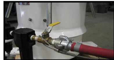
An den **Versorgungsanschluss** ist ein Versorgungsschlauch mit einer Mindestweite von 12,7 mm (0,5 Zoll) anzuschließen. **Hinweis:** In Umgebungen mit hoher Luftfeuchtigkeit ist zusätzlich ein Feuchtigkeitsabscheider erforderlich.
