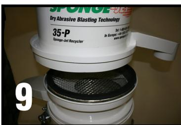
1. **Feinpartikel-Auswurfrohr** durch die Öffnung im **Rüttelteil** stecken. **Hinweis:** Auswurfrohr sorgfältig zentrieren.
