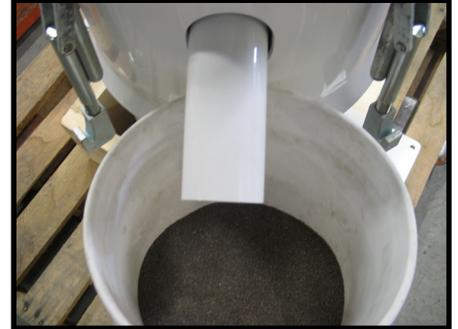
**Wichtig:** Die Bestimmung der zulässigen Staubbelastung ist abhängig von der Arbeitsumgebung. Wenn ein niedrigerer Staubgehalt erforderlich ist, das Sponge Media mehrmals durch den **Füllschacht** schicken.
