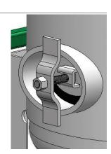
Raccorder le **tuyau de décapage** et sécuriser son raccordement avec du fil torsadé.
