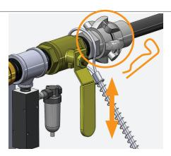
Ouvrir la vanne pneumatique principale d'arrivée d'air.
