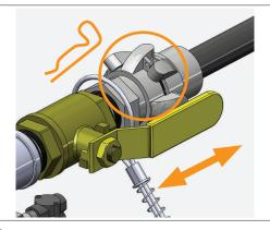
Pointer la **buse de décapage** en direction de la surface de travail (à l'écart du personnel); appuyer sur le levier de sécurité puis sur la poignée **« homme mort »**.
